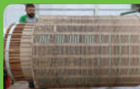
BOBINAGEM DE FORÇA
