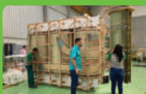
MONTAGEM DE PARTE ATIVA
